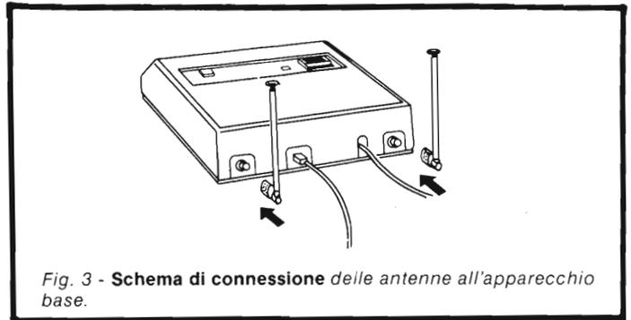
Fig. 3 - Schema di connessione delle antenne all'apparecchio base.
