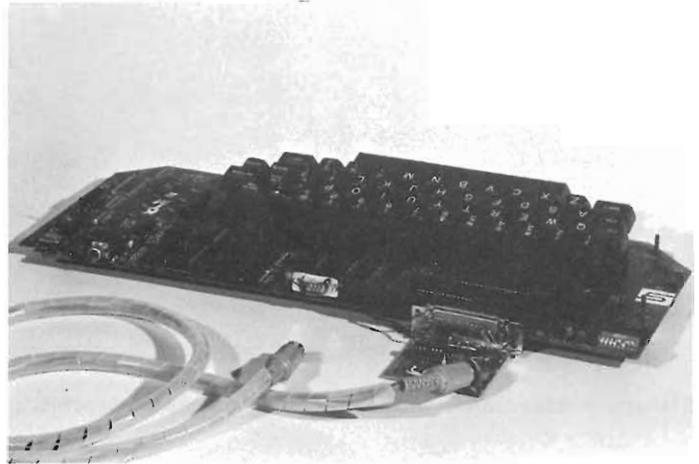
Il KTM 2/80 con il prototipo della interfaccia "20mA-RS232" necessaria per usare il KTM 2/80 col KIM-1, a 9600 BAUD di velocità di trasmissione. Note anche, sulla destra, il "dipswitch" con le opzioni di funzionamento del terminale.
